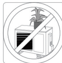
Asegúrese de que nada esté bloqueando las entradas y salidas de aire
