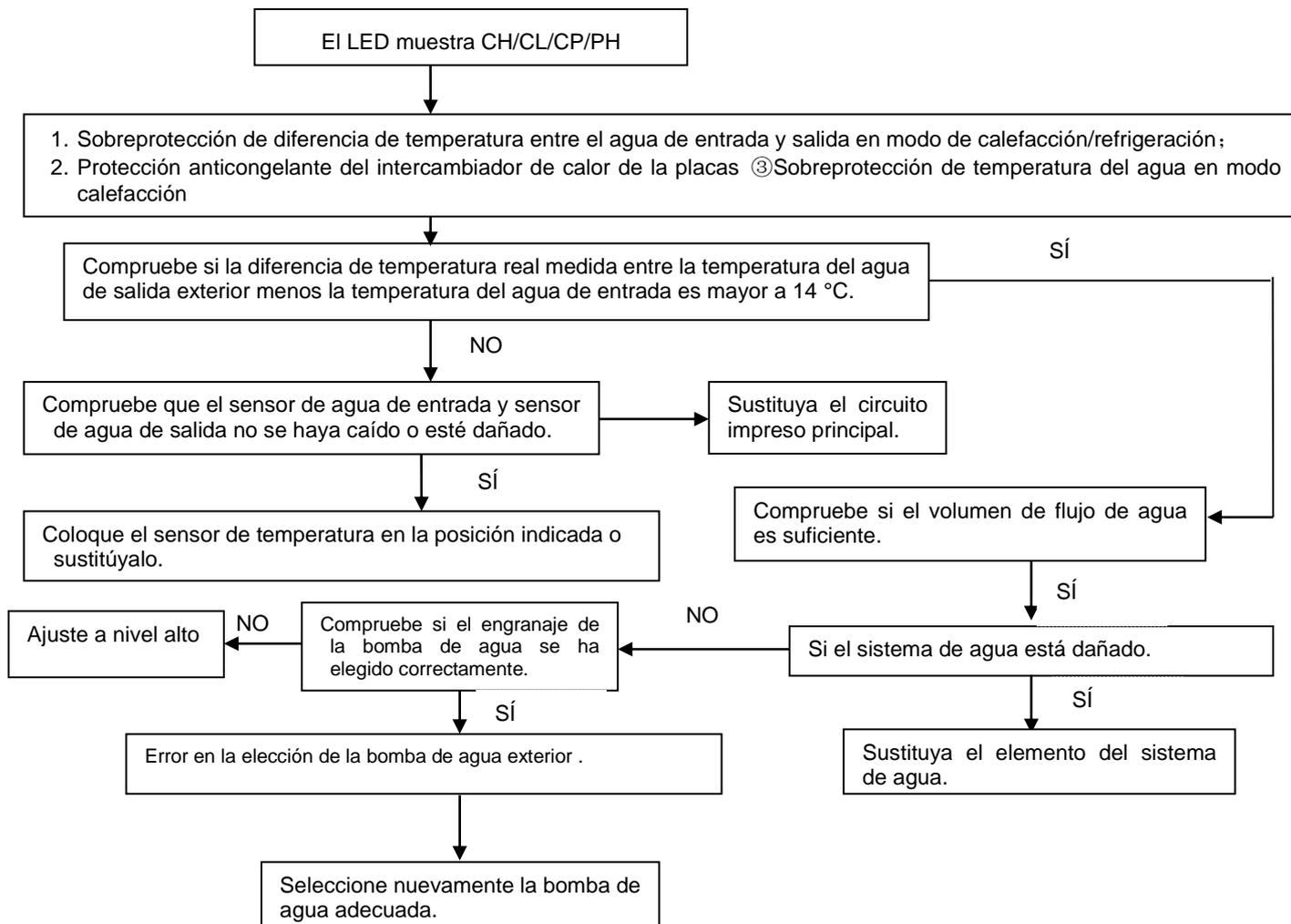
Nota: cuando la temperatura ambiente es inferior a 8 °C y la temperatura de agua de entrada y la temperatura del intercambiador de calor de placas es inferior a 2 °C, el calentador del cárter de la placa se pone en funcionamiento. Aparece CP. Si la temperatura de agua de entrada y la temperatura del intercambiador de calor de placas sube a más de 7 °C, el calentador del cárter deja de funcionar y el código CP desaparece.
