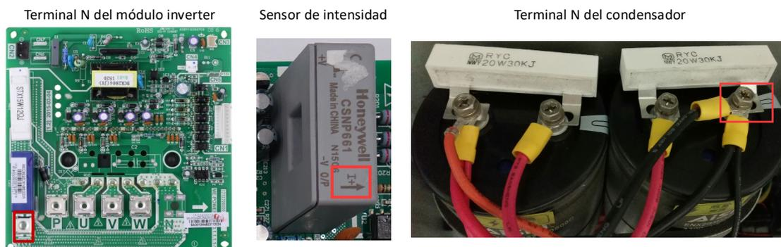
2. Las resistencias normales del compresor inverter son 0,7 - 1,5  $\Omega$  entre U V W e infinito entre cada uno de U V W y tierra. Si alguna de las resistencias difiere de estas especificaciones, el compresor no funciona correctamente.
