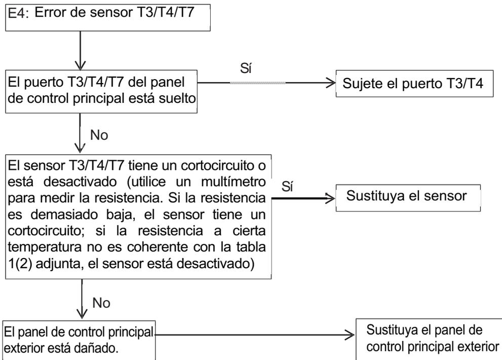
Supuesto: No hay visualización en el panel de control principal, y el problema persiste después de haber sustituido el panel de control principal. Los valores de tensión en la placa de medición (por ejemplo 220 V, 5 V, 12 V, etc.) son normales; tras medir el valor de la resistencia de sensor, vea que el termobulbo T4 está con continuidad de tierra y que el cable térmico del sensor T4 es está punzonado por un perno, como se muestra a continuación:
