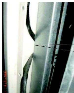
El sensor T4 está gastado y conectado con lámina metálica
