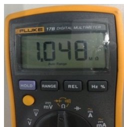
Figura 4-4.4: medición de las resistencias entre los terminales del compresor
