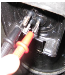
Figura 4-4.4: medición de las resistencias entre los terminales del compresor
