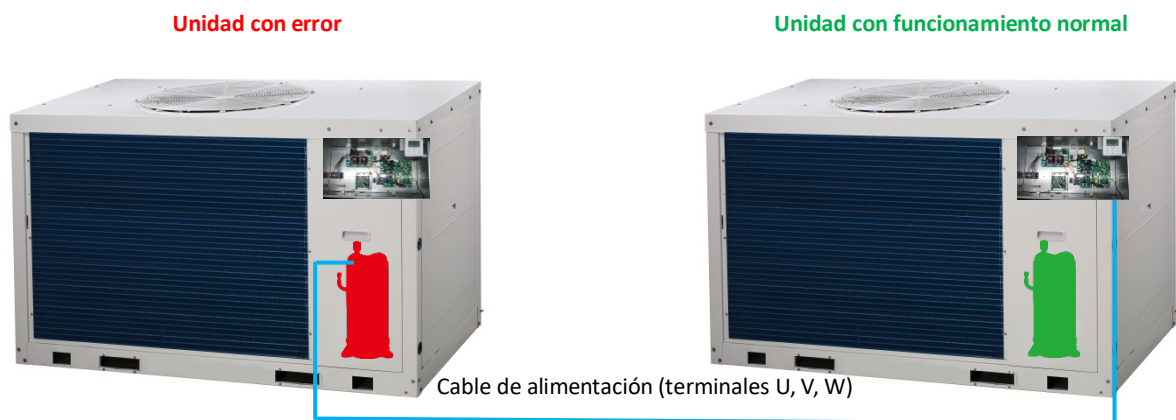
Figura 4-4.11: conexión del compresor a una unidad libre de errores
