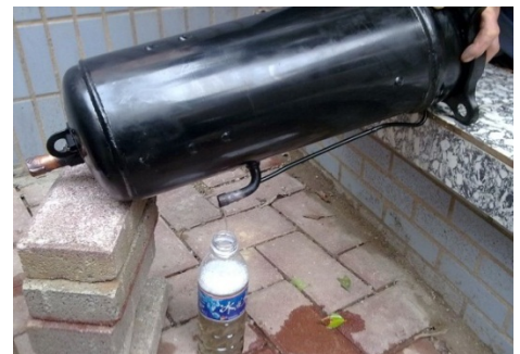
Figura 4-4.12: extracción del aceite del compresor
