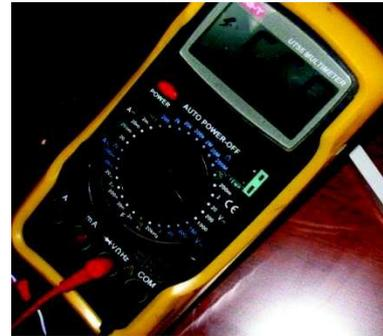
Paso 2: Compruebe la tensión entre los dos capacitadores electrolíticos. El valor normal debe ser 510 V~580 V.
