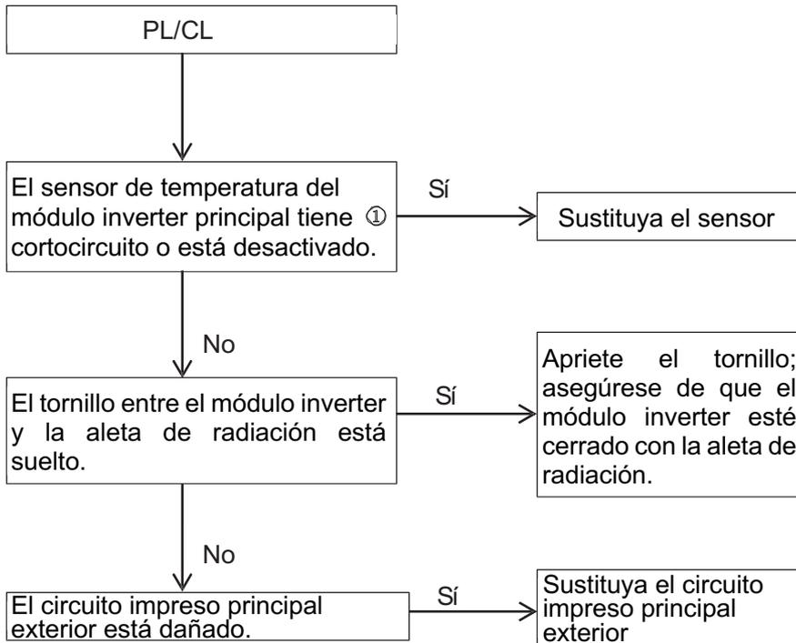
1. Cómo comprobar si el sensor de temperatura tiene un cortocircuito o está desactivado: ①
