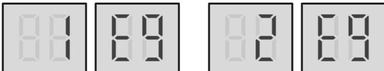
En el código de error, 'x' es un marcador de posición para el sistema del compresor (compresor y componentes eléctricos relacionados), representando 1 el sistema compresor A y 2 el sistema compresor B.
