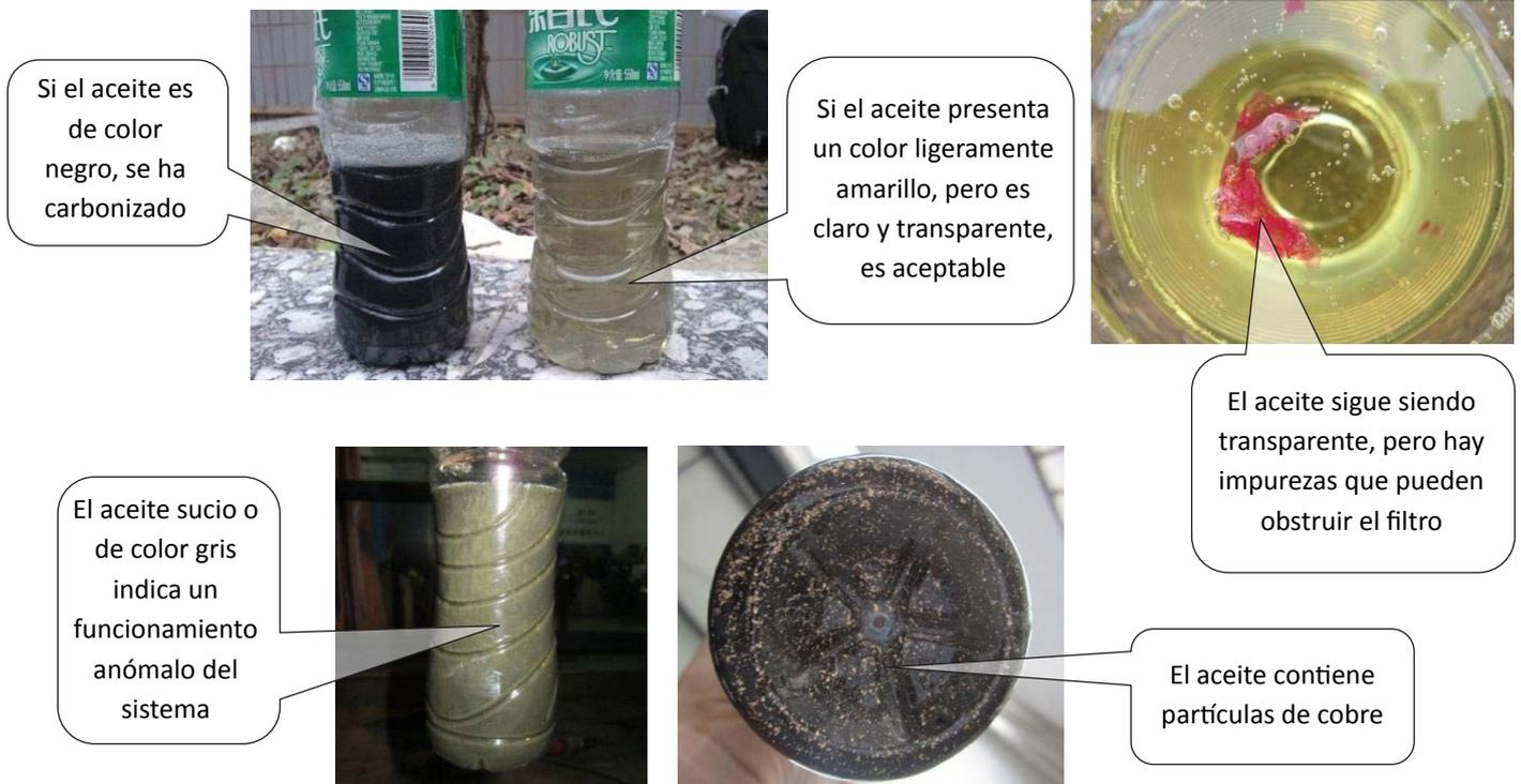
Imagen 6-2.11: Efectos de la presencia de suciedad en el aceite de compresor
