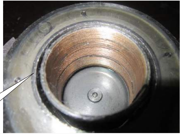
La placa de deslizamiento está desgastada.
