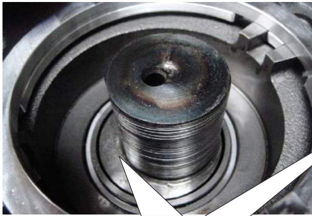
El cigüeñal está desgastado.
