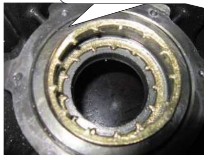
El filtro está bloqueado por impurezas, el aspecto de la admisión y el escape del compresor no serán normales
