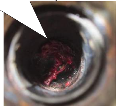
El filtro está bloqueado por impurezas, el aspecto de la admisión y el escape del compresor no serán normales
