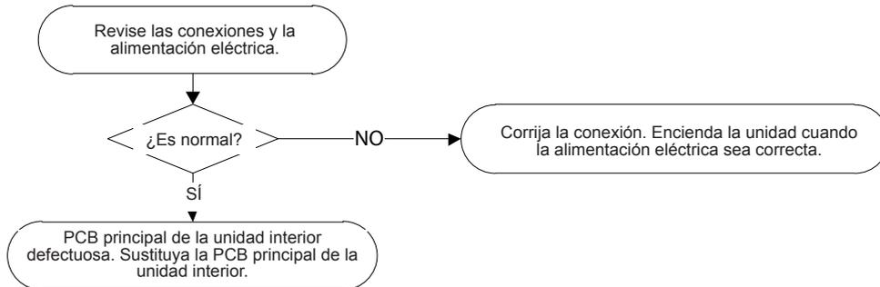
Nota: El error de detección de paso por el punto cero EH 02 solo es válido para las unidades con motor de ventilador de CA; este error no es válido en otros modelos.
