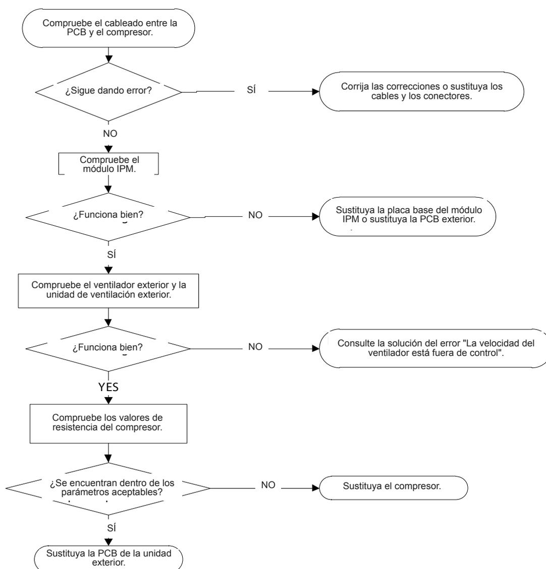
Nota: En algunos modelos, la PCB de la unidad exterior no se puede desmontar individualmente. En esos casos, la caja de control eléctrico de la unidad exterior deberá sustituirse en su conjunto.
