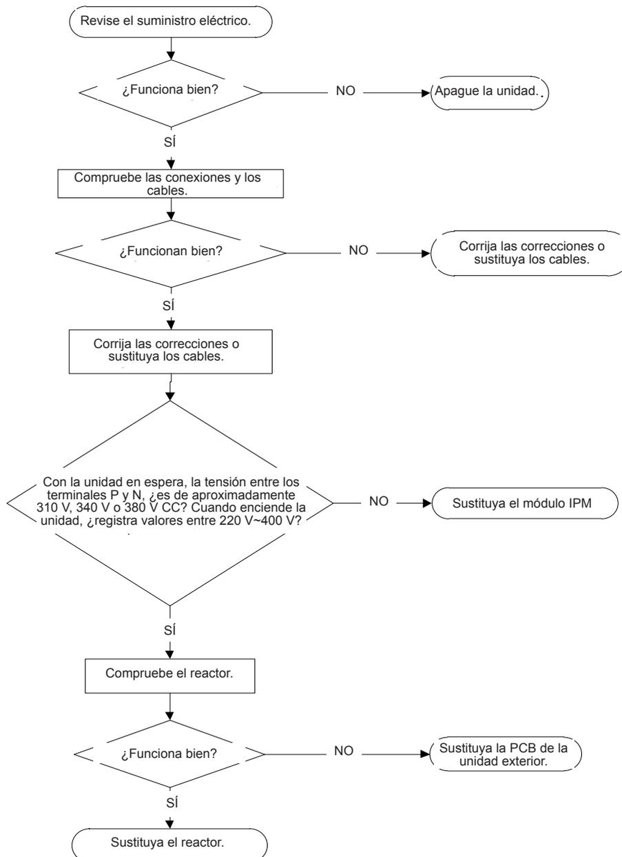
Nota: En algunos modelos, la PCB de la unidad exterior no se puede desmontar individualmente. En esos casos, la caja de control eléctrico de la unidad exterior deberá sustituirse en su conjunto.
