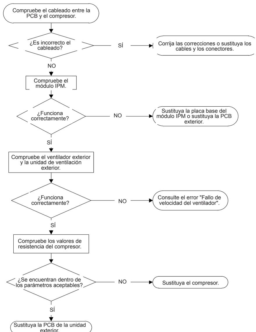
Nota: En algunos modelos, la PCB de la unidad exterior no se puede desmontar individualmente. En esos casos, la caja de control eléctrico de la unidad exterior deberá sustituirse en su conjunto.
