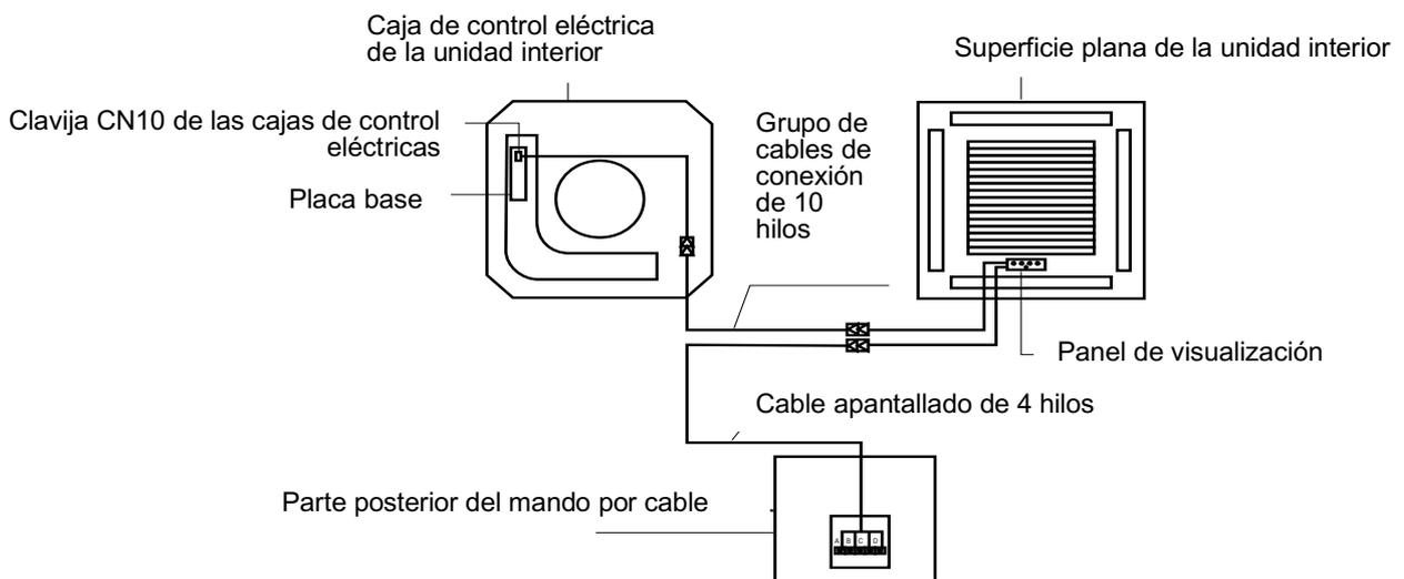
2) Figura del cableado del mando por cable conectado a la unidad interior tipo conducto y estilo patio
