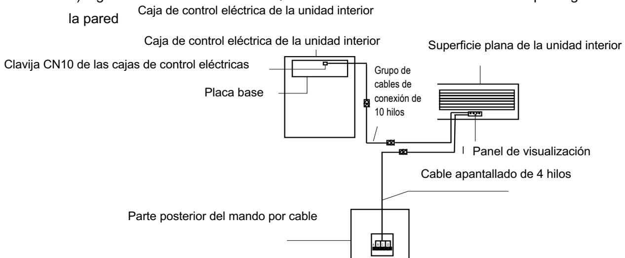
5) Figura del cableado del mando por cable conectada a la unidad interior tipo vertical
