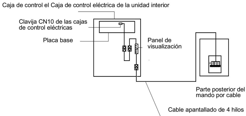
4) Figura del cableado del mando por cable conectado a la unidad interior tipo colgada en la pared
