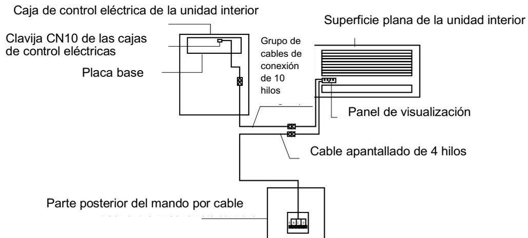
3) Figura del cableado del mando por cable conectado a la unidad interior tipo conducto de presión estática alta.
