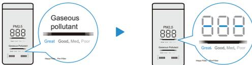
El sensor de olores está El sensor de partículas pre calentado, los estados Excelente, Bueno, Medio pre calentamiento, el valor y Malo se muestran PM2.5 muestra "---". Los alternativamente, y luego estados Excelente, Bueno, se muestran normalmente Medio y Malo se muestran después de 1 minuto.
