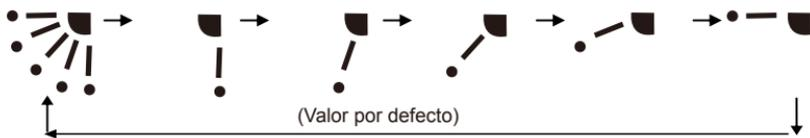
Fig. 37 - Secuencia de ajuste de las lamas verticales
