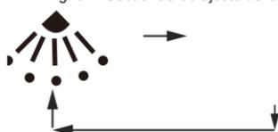
Fig. 38 - Secuencia de ajuste de las lamas horizontales
