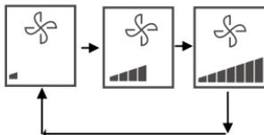
Fig. 28 Secuencia de las 3 velocidades del ventilador automático del HRV
