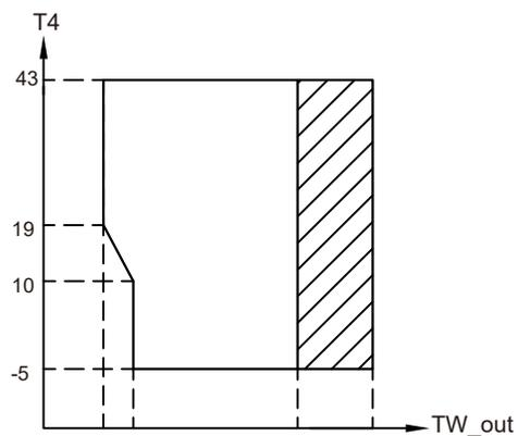
▨ Rango de funcionamiento por bomba de calor con posible limitación y protección.
