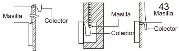
Evite que el agua entre en el mando a distancia con cable, utilice colectores y masilla para sellar los conectores de los cables durante la instalación del cableado.
