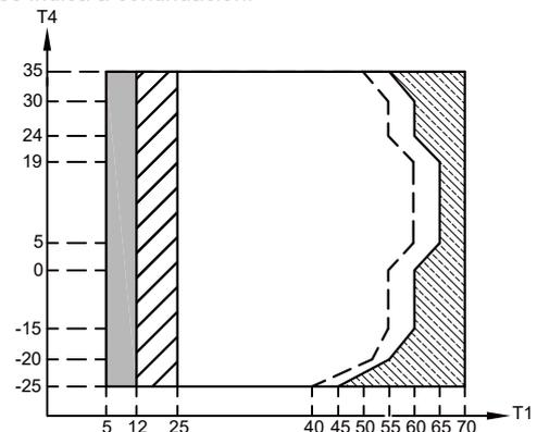
■ Si el ajuste de IBH/AHS es válido, únicamente el IBH/AHS se activa; Si el ajuste de IBH/AHS no es válido, sólo se activa la bomba de calor; pueden producirse limitaciones y protecciones durante el funcionamiento de la bomba de calor.
