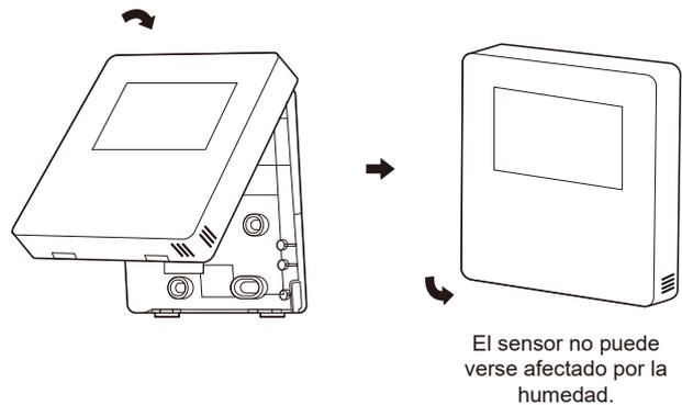
Instale correctamente la cubierta trasera y encaje firmemente las cubiertas frontal y trasera; de lo contrario, la cubierta frontal se caerá.
