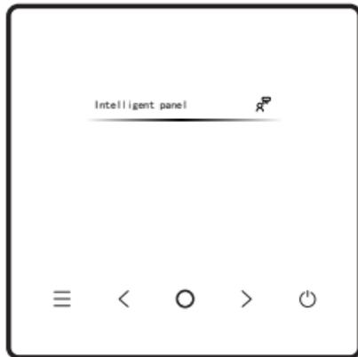
Seleccione el ajuste en el menú y pulse «○» para confirmar. Tras acceder a la interfaz de ajuste de funciones, pulse «<» o «>» para cambiar de función, y pulse «○» para activar la función seleccionada.
