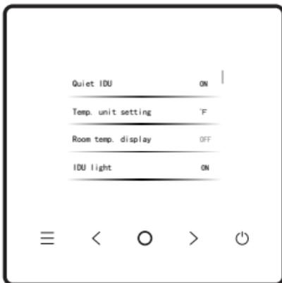
De forma predeterminada, la unidad de temperatura es Celsius. Puede cambiar manualmente la unidad entre Celsius y Fahrenheit. Puede pulsar «○» para activar o desactivar la unidad de temperatura.
