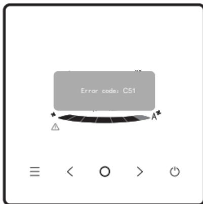
1. En caso de que falle alguna IDU u ODU, el controlador cableado muestra el código de fallo. En caso de que se produzca un fallo de comunicación entre el controlador cableado y cualquiera de las IDU, el controlador cableado indica «C51».
