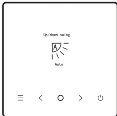
Seleccione la función de oscilación arriba/abajo (izquierda/derecha) en el menú y pulse «○» para confirmar. Después de acceder a la interfaz de oscilación, pulse «<» o «>» para ajustar el ángulo de oscilación, o pulse «≡» para volver al menú.
