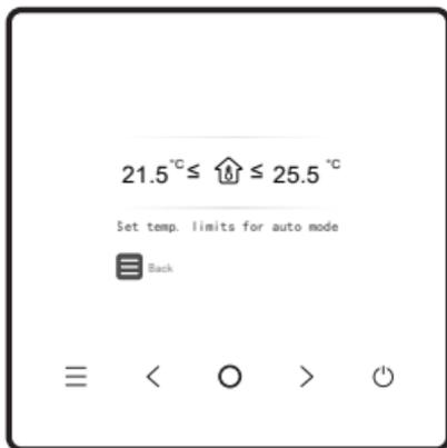
El ajuste de la temperatura en el modo automático le permite ajustar la temperatura en el modo automático de refrigeración/calefacción y mantener la temperatura interior dentro del rango ajustado. Pulse «○» para acceder al ajuste de temperatura en modo Auto, pulse «○» para seleccionar un elemento y pulse «<>» y «>>» para ajustar el rango.
