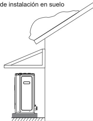
Si existe riesgo de que la nieve se deslice desde el techo, se debe instalar un techo o una cubierta protectora para proteger la bomba de calor, las tuberías y el cableado.
