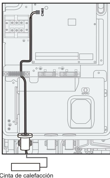
Para la cinta calefactora de tubería de drenaje, la potencia no debe exceder los 40 W. La corriente de trabajo es de hasta 200 mA, la tensión alimentación es de 230 VCA.
