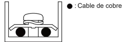
Conexiones del cableado de alimentación correctas
