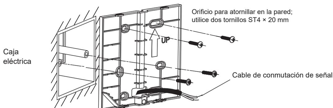
Orificio para tornillos en la caja eléctrica tipo 86; utilice dos tornillos M4 x 25 mm
