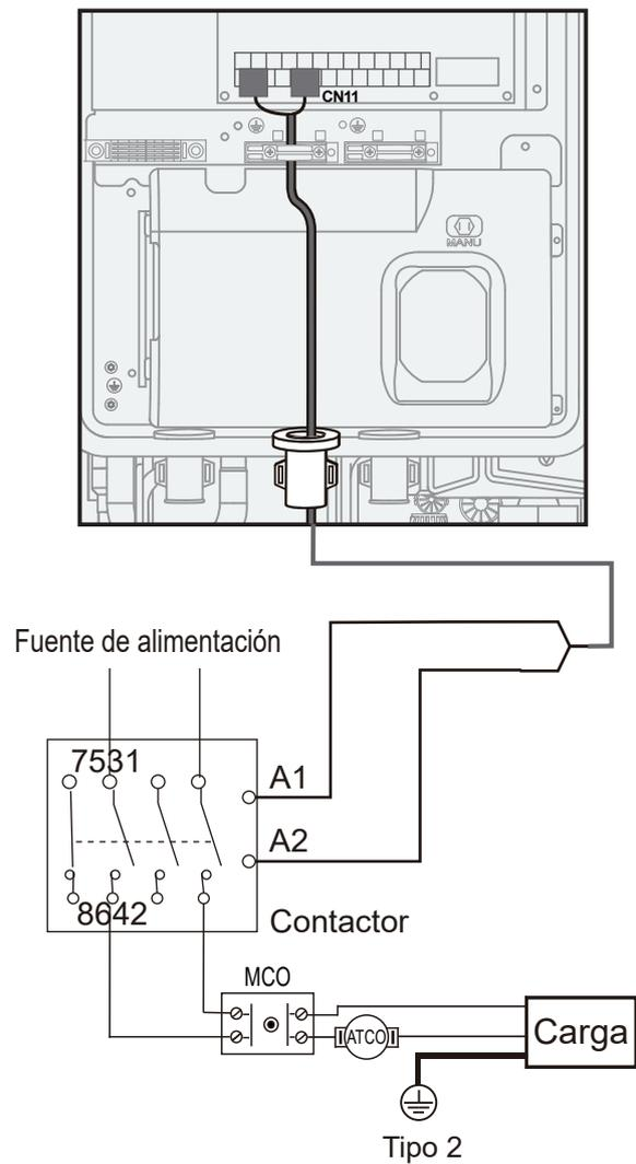
Puerto de señal de control del módulo hidráulico: El CN11 contiene terminales para la válvula de 3 vías, la bomba, el refuerzo y el calefactor, etc.
