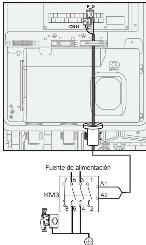
Bomba de energía solar P<sub>s</sub>:
