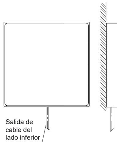
Cableado interior de pared (con caja tipo 86)
