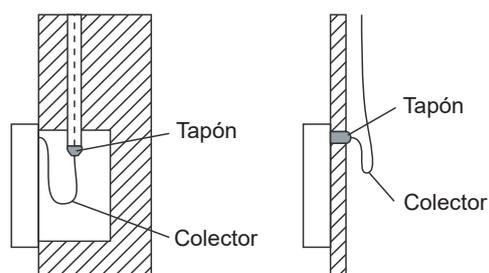
Evite que el agua entre en el mando a distancia con cable y utilice colectores y masilla para sellar los conectores de los cables durante la instalación del cableado.
