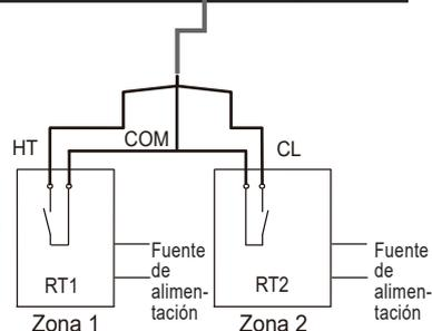
El cable del termostato puede conectarse de tres formas (como se describe en las figuras anteriores) y el método de conexión específico depende de la aplicación.
