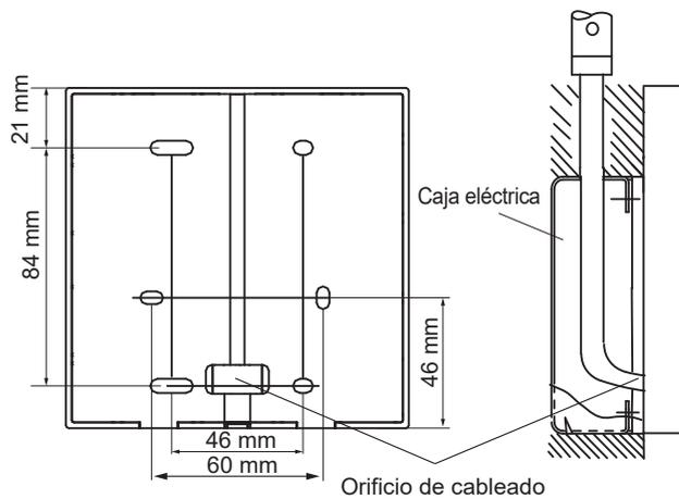
Cableado interior de pared (sin caja tipo 86)
