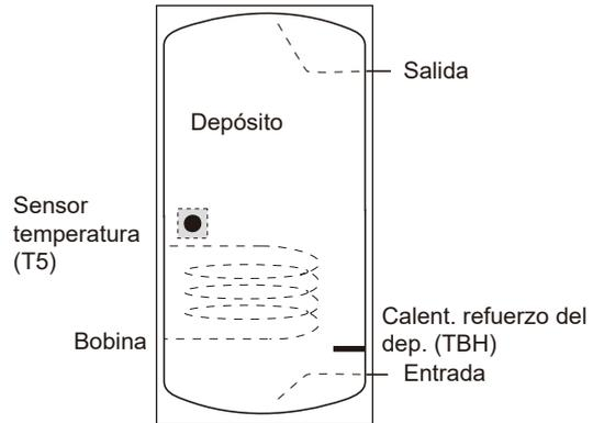
El calentador de refuerzo debe instalarse debajo de la sonda de temperatura (T5).
