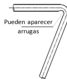
Figura 3-5.3: Curvatura de la tubería superior a 90^\circ
