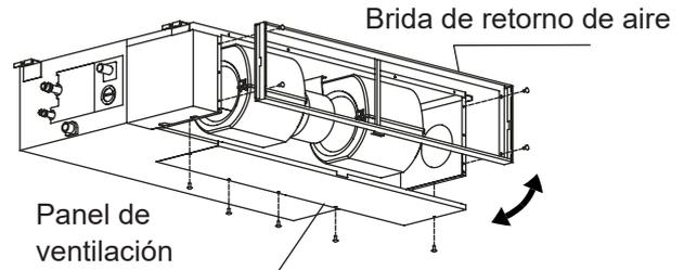
Doble el panel de ventilación posterior en 90 grados a lo largo de línea punteada en un panel de ventilación descendente. (algunos modelos)
