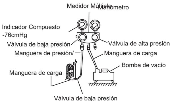
6. Cierre el lateral de baja presión del medidor múltiple y apague la bomba de vacío.
