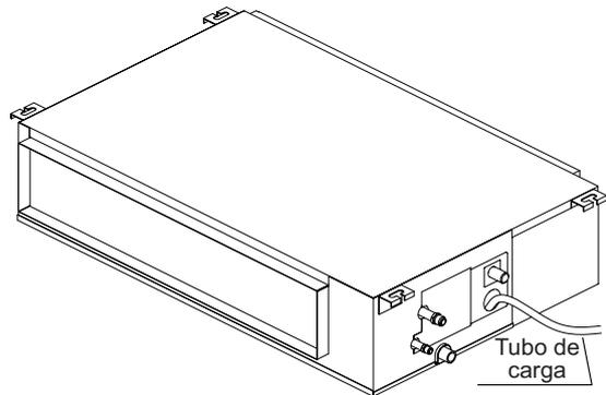
2. Encienda la unidad en modo Cooling (Refrigeración). Escuchará la bomba de drenaje. Verifique si se descarga el agua correctamente (es posible un retraso de un minuto, dependiendo de la longitud del tubo de drenaje), verifique si hay fugas de agua en las juntas.
