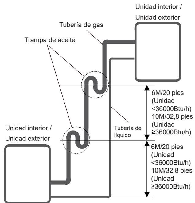
Conexión de tubería de refrigerante
