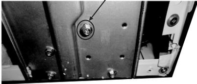
7. Retire el tornillo con el destornillador.
