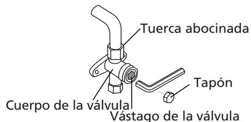
12. Utilizando una llave hexagonal, abra por completo las válvulas de alta presión y baja presión.
