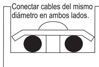
**D** No presione los cables de alimentación del mismo diámetro en el mismo lado del terminal. No utilice dos cables de alimentación de distinto diámetro para los mismos bloques de terminales; de lo contrario, pueden aflojarse fácilmente debido a una presión desigual y provocar accidentes, como se muestra en la figura siguiente.
