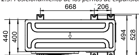
Imagen 3-2.5: Posicionamiento de los pernos de expansión y espacios (unidades: mm)
