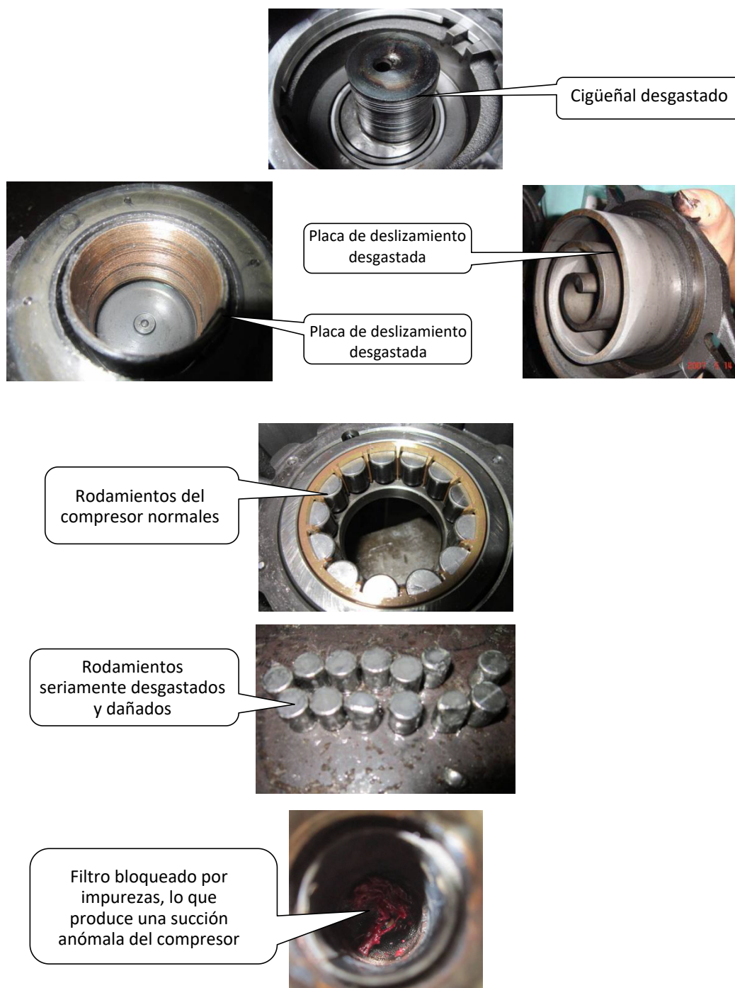
Imagen 6-2.11: Efectos de la presencia de suciedad en el aceite de compresor
