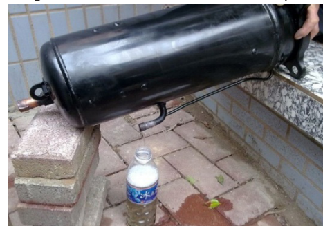
Imagen 6-2.8: Drenar el aceite de un compresor
