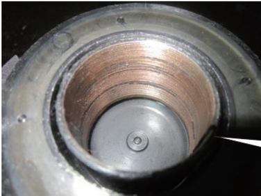
Placa de deslizamiento desgastada
