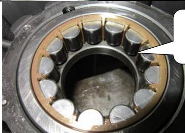
Rodamientos seriamente desgastados y dañados
