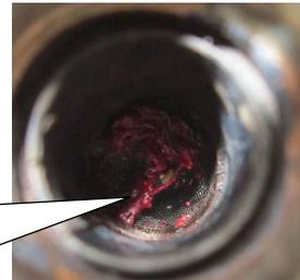
Placa de deslizamiento desgastada
