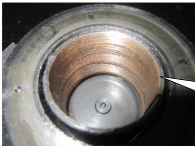
Placa de deslizamiento desgastada
