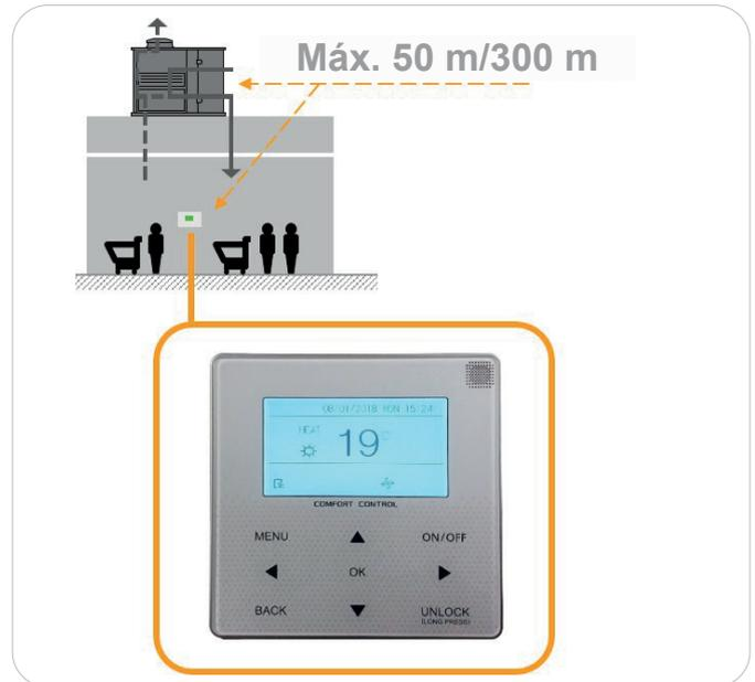
Con una fuente de alimentación independiente, la conexión puede ampliarse hasta 300 m.
